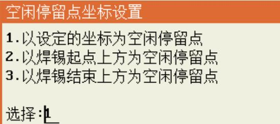
一般的焊锡加工可以选择 2 或 3 项工作效率会高些；但如需要将烙铁移开以方便更换加工的产品则可选择设置的坐标。
