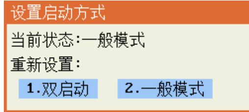
双启动：按下总运行键后，放好产品，按下 Y1 启动，Y1 夹紧气缸工作，夹紧完成后等待烙铁头空闲时加工。按下 Y2 启动，Y2 夹紧气缸工作，夹紧完成后等待烙铁头空闲时加工。双启动区分 Y1 和 Y2 轴启动。
