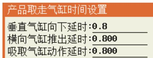
垂直气缸向下延时：垂直气缸电磁阀的输出时间；
