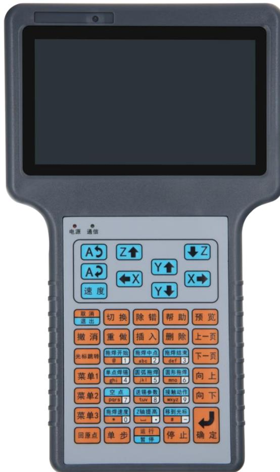
3. 程序组别选择及手动对针小键盘（107mm \* 40mm）、电路板（70mm \* 40mm）。
