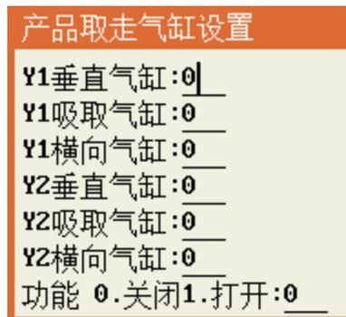
此功能是为了实现自动取走加工完的产品，各气缸端口号与实际接线一致，注意端口不能复用。
