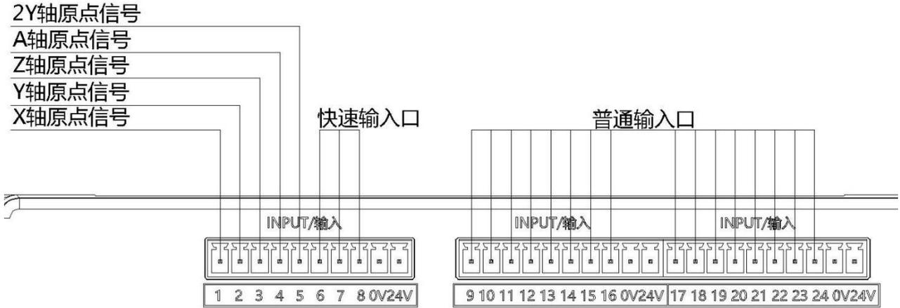
输入口典型接线：继电器中转方式
